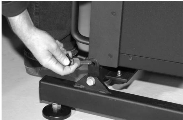
Der Kugelsperrbolzen muss vollständig eingesteckt werden und bündig anliegen, der Auslöseknopf muss vollständig zurückgesprungen sein. Ein Ausrücken der Sicherungskugeln kann optisch überprüft werden.
