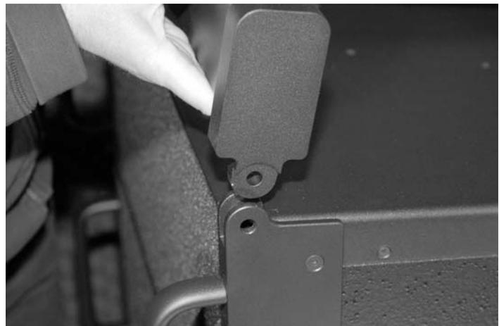
Verriegeln Sie die vorderen Flugmechaniken **beiderseits** mit dem dazugehörigen Kugelsperrbolzen. Durch Eindrücken des zentralen Auslöseknopfes geben die Sicherungskugeln nach und der Stift passt in die Bohrung. Der Kugelsperrbolzen muss vollständig eingesteckt werden und bündig anliegen, der Auslöseknopf muss vollständig zurückgesprungen sein. Ein Ausrücken der Sicherungs-
