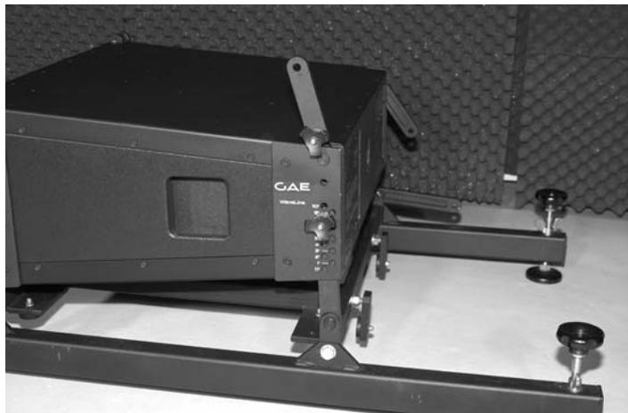
Sollte sich der letzte hintere Bolzen nicht einführen lassen, so kann mit Hilfe der Justierungsspindel das Stack-Cradle so ausnivelliert werden, dass ein Verzug ausgeglichen wird und der Bolzen eingesetzt werden kann.
