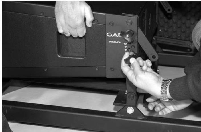
Verriegeln Sie die hinteren Flugmechaniken **beiderseits** mit dem dazugehörigen Kugelsperrbolzen. Durch Eindrücken des zentralen Auslöseknopfes geben die Sicherungskugeln nach und der Stift passt in die Bohrung.
