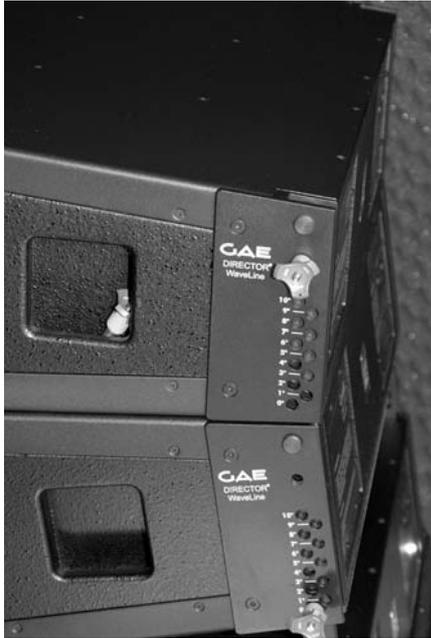
Die Elemente liegen nun bündig auf. Entfernen Sie jetzt den oberen in der Parkposition befindlichen Kugelsperrbolzen des unteren Elements. Diesen können Sie in der Griffmulde des oberen Elements ablegen.
