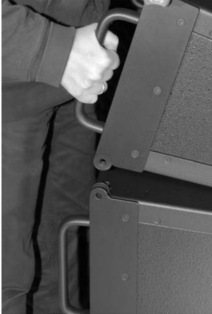
Nun kann die vordere Verbindungsmechanik ohne Verkanten abgesenkt werden. Die Mechaniken müssen passgenau ineinander eingeführt werden. Achten Sie darauf, dass die Zapfen und Gabeln schmutzfrei sind.
