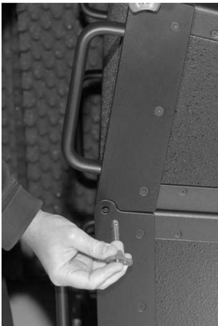
Verriegeln Sie die vorderen Flugmechaniken **beiderseits** mit dem dazugehörigen Kugelsperrbolzen. Durch Eindrücken des zentralen Auslöseknopfes geben die Sicherungskugeln nach und der Stift passt in die Bohrung.
